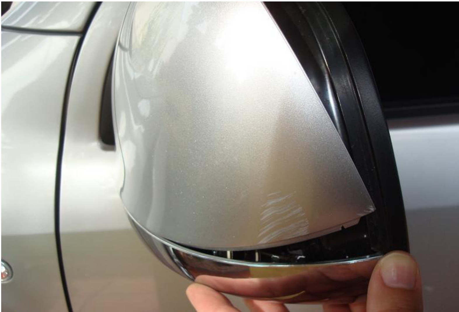
Liberar con una punta los anclajes del film que estan marcados con rojo FOTO 3
