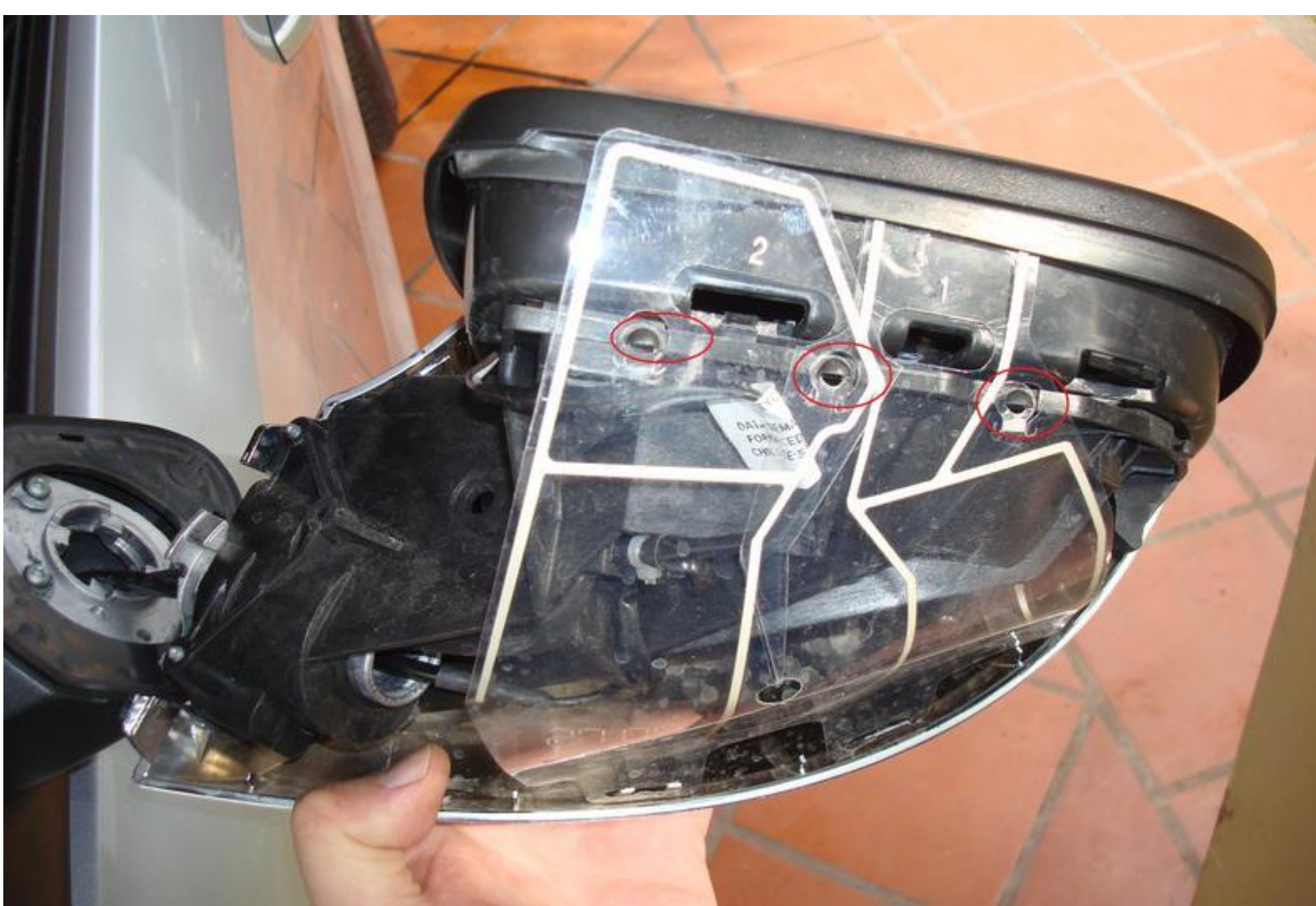
destornillar el modulo (todos los tornillos son con cabeza Torx) FOTO 4
