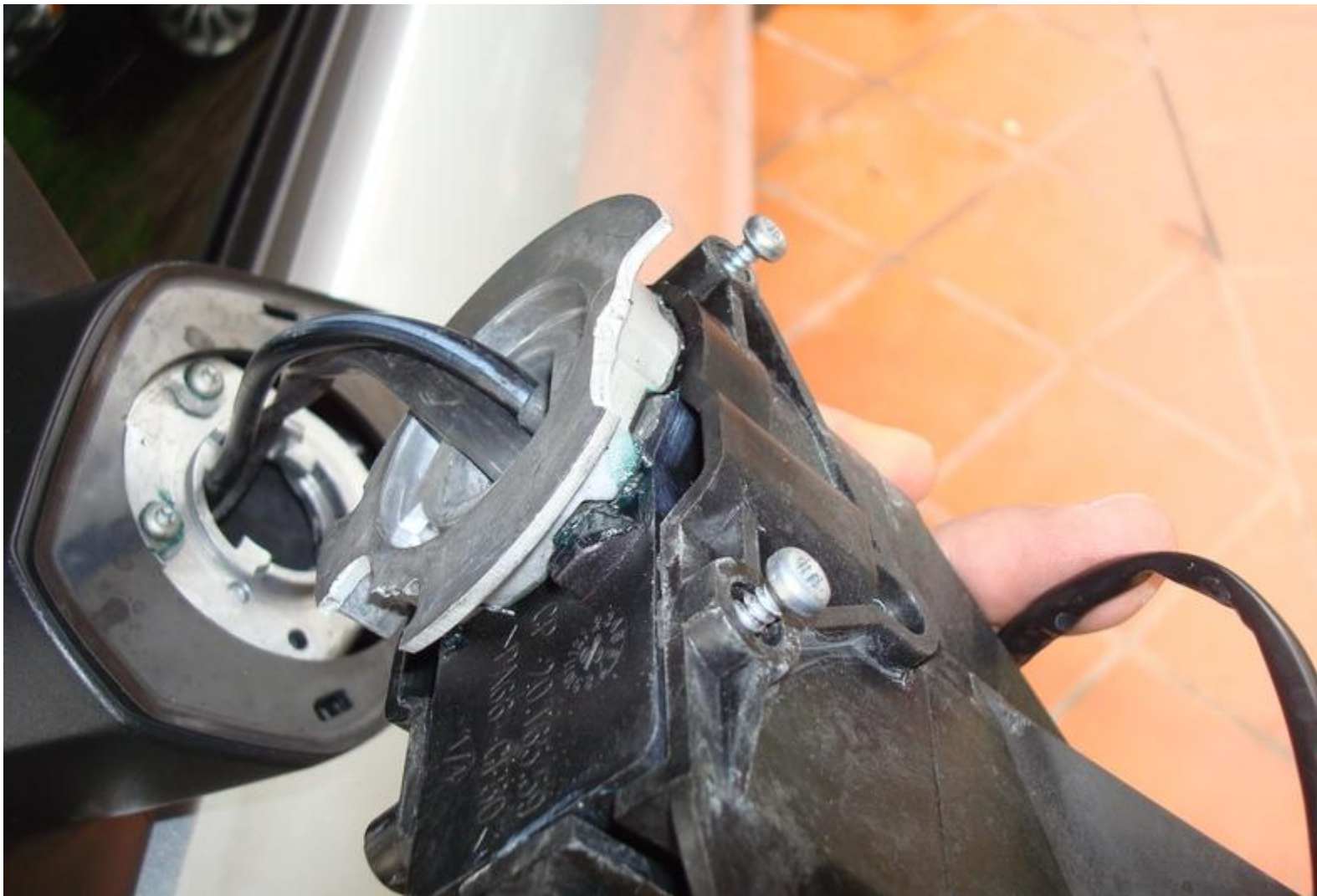
Ahora si nos queda libre la pieza a tratar ALE fíjate que el anclaje de la pieza no afecta el mecanismo para rebatir el espejo Foto 8
